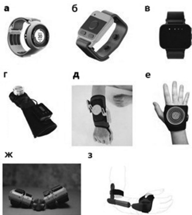
Рис. 1. Обзор разработанных устройств: а) Cala Trio — браслет с системой чрескожной афферентной стимуляции срединного и лучевого нервов, б) Encaro Plus — вибрационный терапевтический браслет, в) Felix NeuroAI — система чрескожной стимуляции периферических нервов, г) GyroGlove — система гироскопической стабилизации, д) Tremolo — демпфирующая система с настроенной добавленной массой, е) Stedi-Two — система магнитной стабилизации, ж) Move-D — механический ортез локтя, з. STILL orthosis — ортез с демпфирующей системой [7]
